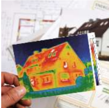
Thermografie deckt Wärmeverluste von Gebäuden auf. Foto: Umwelt- und-EnergieAgentur Kreis Karlsruhe.
